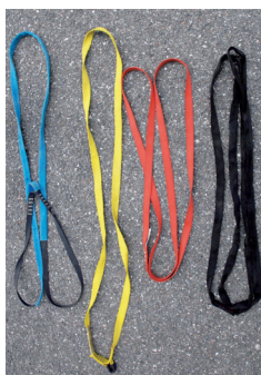
Bandschlingen fallen unter die Norm EN 795B.
