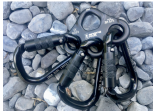
„Verteiler“ für die gleichzeitige Anbringung von 3 Karabinern.
