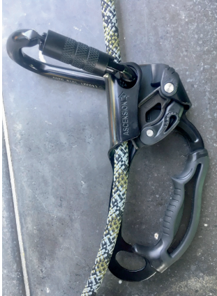
Steigklemme am Seil und mit den aufgedruckten Angaben des Herstellers.
