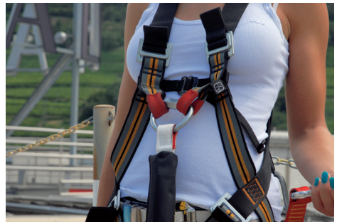
Vorne, am Brustanschlag, dieser sollte sich in der Nähe des Brustbeines befinden. N.B.: Sollte der Gurt über Anschlagsschlingen (wie in diesem Bild) verfügen, ist es sinnvoll ein „Schraub - Glied“ Karabiner als Zwischenverbindungsstück ein zusetzen, da dieser imstand ist, in allen Positionierungen die gesetzlich garantierte Minimumkraft von 15 KN aufzunehmen (1KN entspricht 98,1 kg also ungefähr 100 kg).
