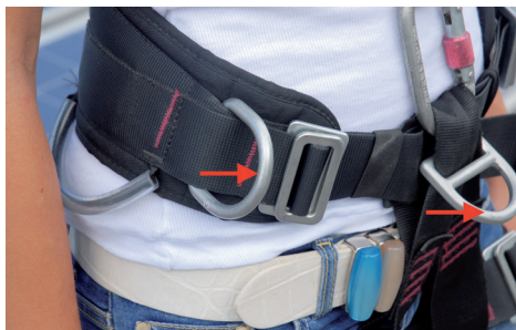
Positionierungspunkte bei einem Absturzsicherungsgurt.
