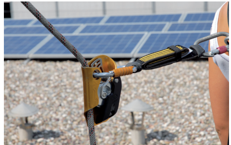
Auffangsystem, fest montiert an einer Stütze, speziell geeignet für wiederkehrende Wartungsarbeiten.
