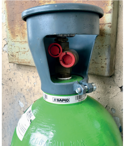
Gasflasche mit Kragen zum Schutz des Ventils
