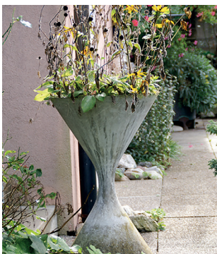
Blumenkisten aus Asbestzement
