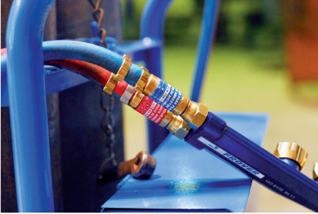
Bei Brennschneidarbeiten mittels Acetylen und Sauerstoff immer genormte Flammenrückschlagventile einsetzen.
