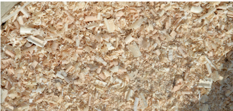
Speziell feines Material, wie hier Holzspäne oder Stahlwolle, lässt sich bereits durch einen überspringenden Funken leicht entzünden.
