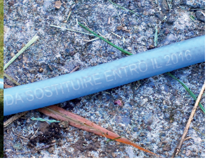
Die Anschlüsse von Flüssiggasflaschen sollen schadfrei und die Schläuche nicht beschädigt sein. Sie sollten regelmäßig laut Angaben des Herstellers ausgetauscht werden (bei diesem Modell ist das Verfallsdatum angegeben)
