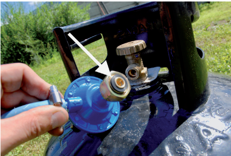
Die Dichtung am Anschluss ist bei jedem Flaschenwechsel ebenfalls auszutauschen.
