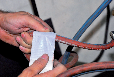
Keine provisorischen Reparaturen an den Schläuchen und Armaturen durchführen.
