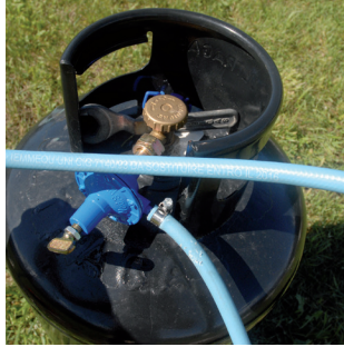
Die Anschlüsse von Flüssiggasflaschen sollen schadfrei und die Schläuche nicht beschädigt sein. Sie sollten regelmäßig laut Angaben des Herstellers ausgetauscht werden (bei diesem Modell ist das Verfallsdatum angegeben)
