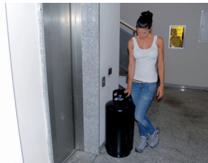
Flüssiggasflaschen nicht auf Lichtschächten, in unterirdischen Kellerräumen, neben Aufzugschächten oder im Treppenhaus lagern. Propan- und Butangase sind schwerer als Luft und könnten sich, sofern freigesetzt, am tiefsten Punkt sammeln und sofort ein gefährliches Gas-Luft-Gemisch bilden.
