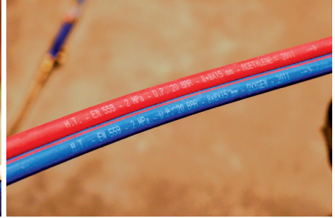
Auf intakte, genormte und farblich unterschiedlich gekennzeichnete Druckgasschläuche achten - die Vorgabe des Herstellers hinsichtlich Austausch ist zu beachten (hier ist das Produktionsjahr am Schlauch selbst angegeben).
