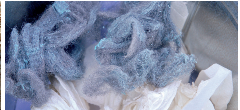
Speziell feines Material, wie hier Holzspäne oder Stahlwolle, lässt sich bereits durch einen überspringenden Funken leicht entzünden.
