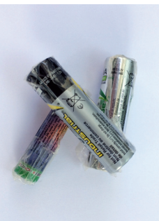
Richtige Zwischenlagerung von Batterien und Akkus mit Hüllen oder Abdeckungen
