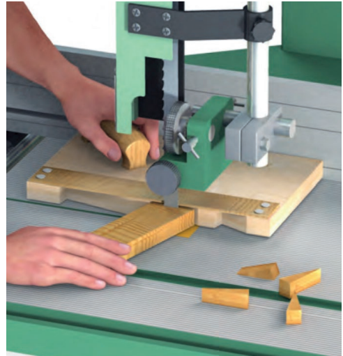
Keilschneiden mit Keilschneidlade
