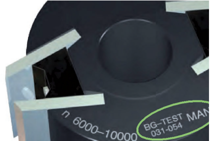
Kennzeichnung am Fräswerkzeug: zum manuellen Handvorschub geeignet
