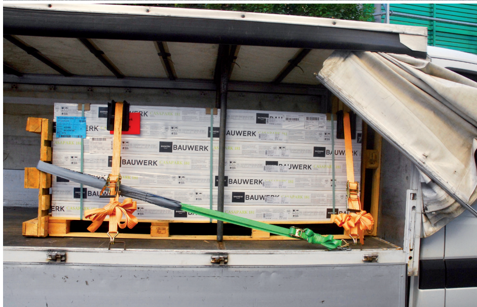
Sicherung mittels Einsatz von Spanngurten, Kantenschoner, Europaletten, Antirutschmatten, sowie einer Behelfsschlinge (der grüne Spanngurt und die Hebeschlinge soll ein verrutschen der Ladung nach hinten und zu den Seiten verhindern) – Positionierung der Ladung bündig an der Fahrerstorseite und mit einer Palette nochmals abgesichert
