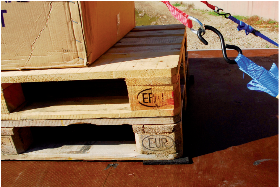
Einsatz eines Ladesicherungsnetzes, Kantenschonleisten, Unterlagepaletten (Europaletten) und Antirutschmatten
