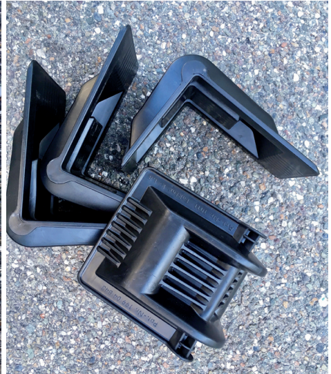
Kantenschoner (ermöglichen auch ein gleichmäßiges Anziehen des Spanngurtes)
