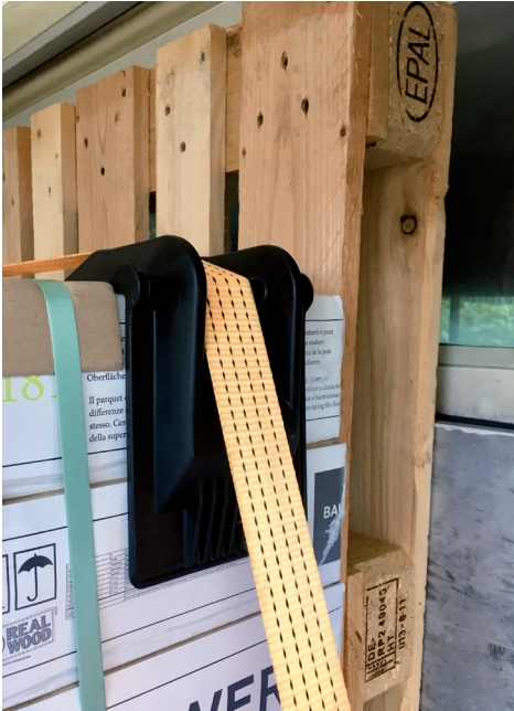
Detail der Absicherung zwischen Ladegut und Palette mit angrenzender Fahrerkabine
