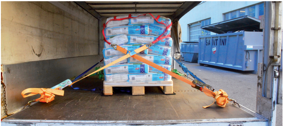
Sicherung einer Palette mit Sackware mittels eines Netzes (die Ladung wurde versucht auf die hintere Achse zu positionieren)
