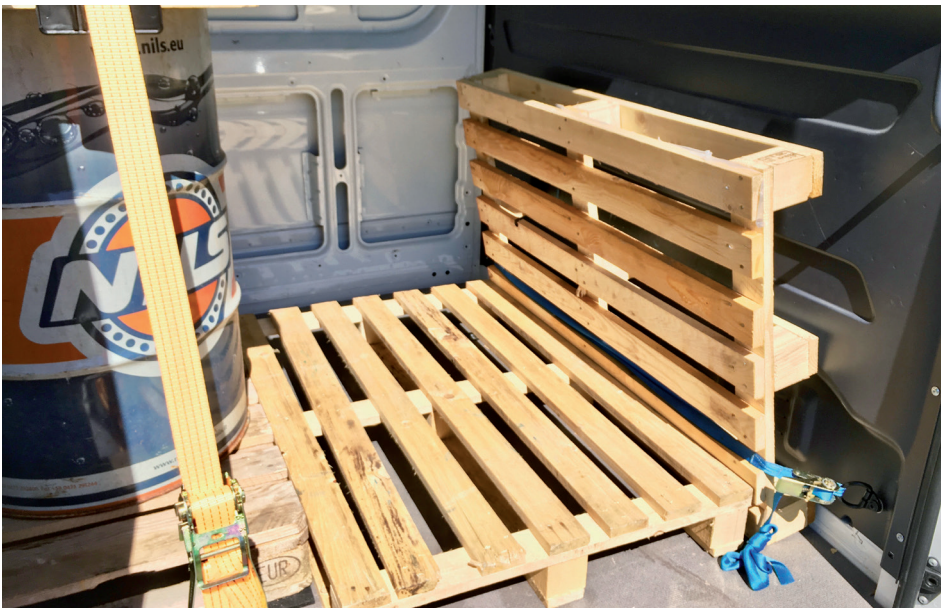
Die Palette wurde mittels eines Spanngurtes gegen ein „verrücken“ gesichert.
