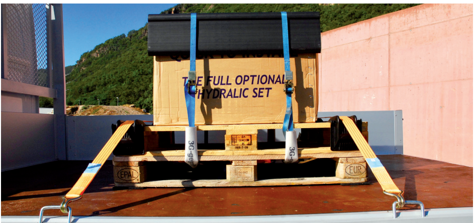
Sicherung mittels Einsatz von Spanngurten; Kantenschoner, Kantenschonerleisten, Europaletten und Anti-rutschmatten – Positionierung der Ladung mittig der Hinterachse
