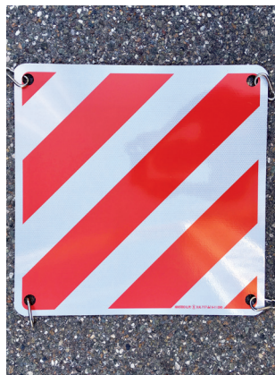
Pflichtschild für über die Lade- fläche (nur für hinten zulässig) ragende, nichtteilbare Transport- gegenstände, welche nicht mehr als 3/10 der Fahrzeuglänge errei- chen (Lieferautos).
