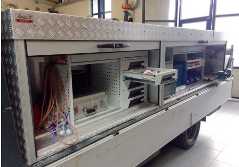
(Quelle Pallabazzer) Mobile Transportbox, geeignet für die Aufnahme mittels Hebemittel und auf den sicheren Transport auf der Ladefläche eines Lieferautos
