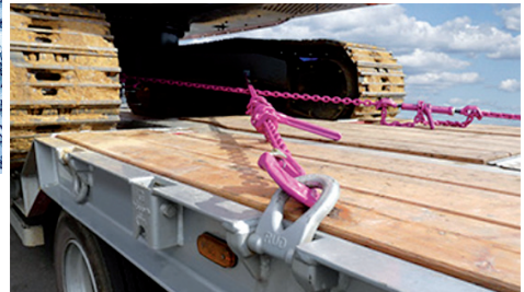
(Quelle: RUD) Verankerung einer Erdbewegungsmaschine mittels einer Spannkette
