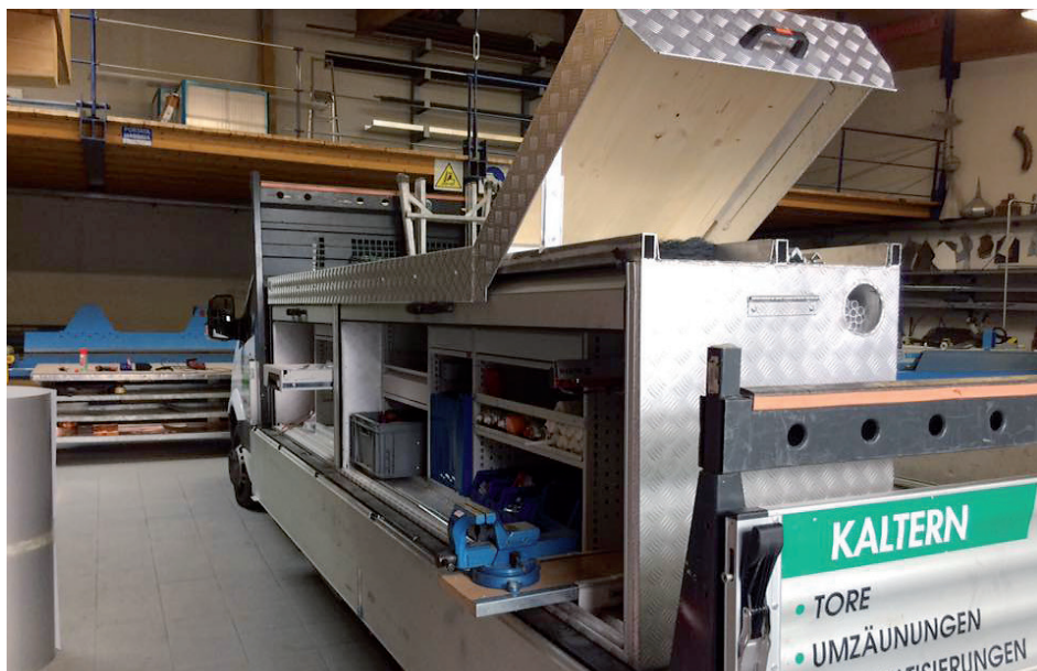
(Quelle Pallabazzer) Detaillösung zum schnellen und sicheren Transport von Metallschienen und Rohre
