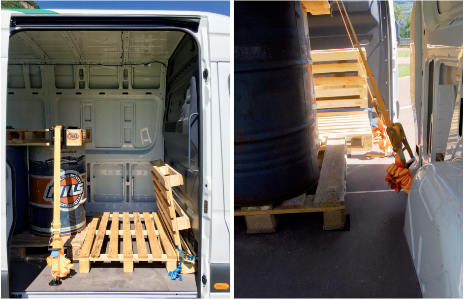
Beispiel einer Sicherungsmethode von 200lt Fässer mittels Paletten, Antirutschmatten, Spanngurte, Kantenschoner und einem kraftschlüssigen Verbau mittels Paletten zum Aufbau der Fahrerkabine hin.
