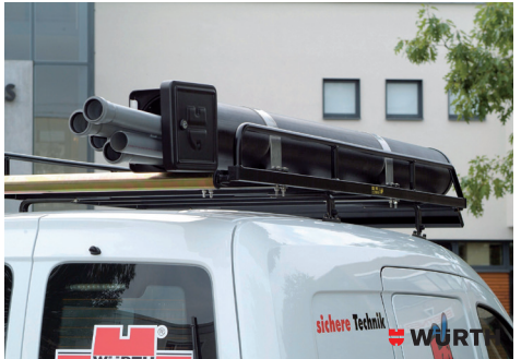
(Quelle Würth) Detail zum Transport von Rohren und Profilen
