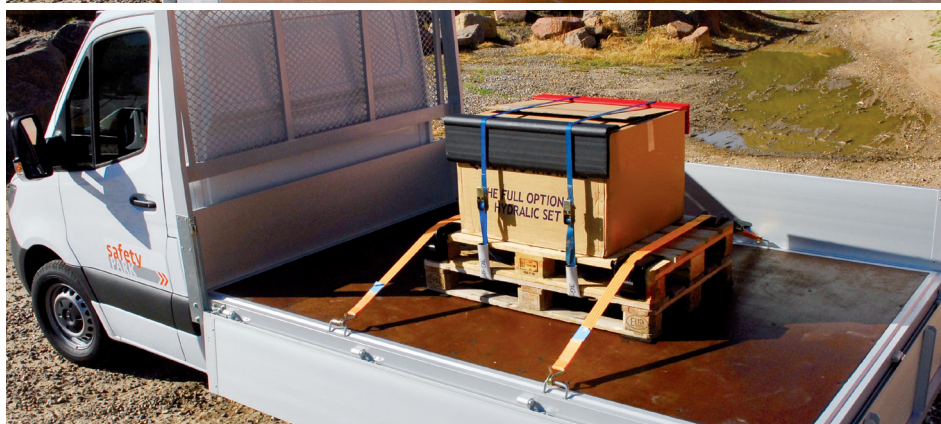
Sicherung mittels Einsatz von Spanngurten; Kantenschoner, Kantenschonerleisten, Europaletten und Anti-rutschmatten – Positionierung der Ladung mittig der Hinterachse
