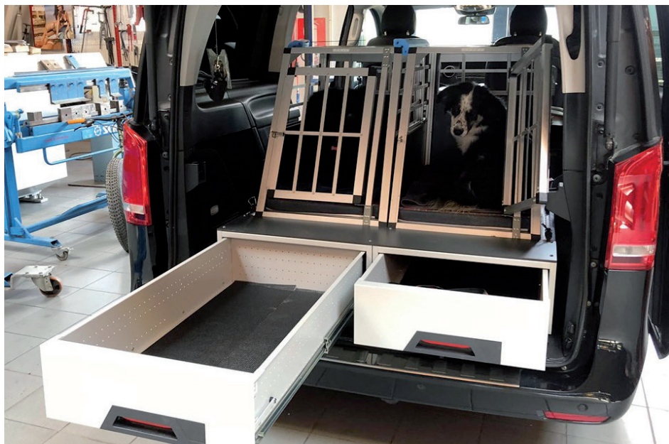
(Quelle Pallabazzer) Ausbau mit Schubladensystem und Hundezwinger (zum Schutz des besten Freundes)
