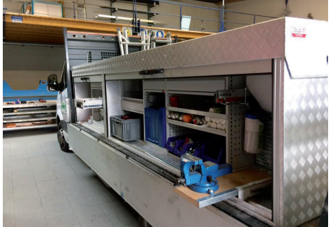
(Quelle Pallabazzer) Mobile Transportbox, geeignet für die Aufnahme mittels Hebemittel und auf den sicheren Transport auf der Ladefläche eines Lieferautos
