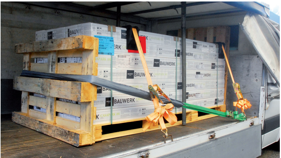
Detail der hinteren Absicherung mittels Europalette und Behelfsschlinge
