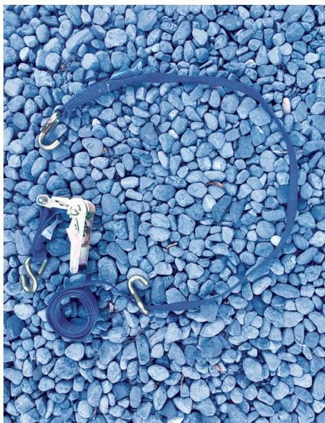
Befestigungsgurt für Fahrzeuge, die beiden Haken werden am Lochblechboden des Transportmittels (z.B. Hänger) befestigt, der Gurt umfasst dann den Reifen des zu transportierenden Fahrzeuges in Längsrichtung.
