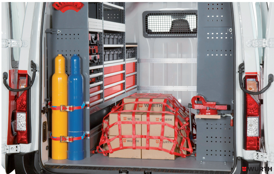
(Quelle Würth) Sichere und einfach durchführbare Ladungssicherung von Gasflaschen im Lieferauto
