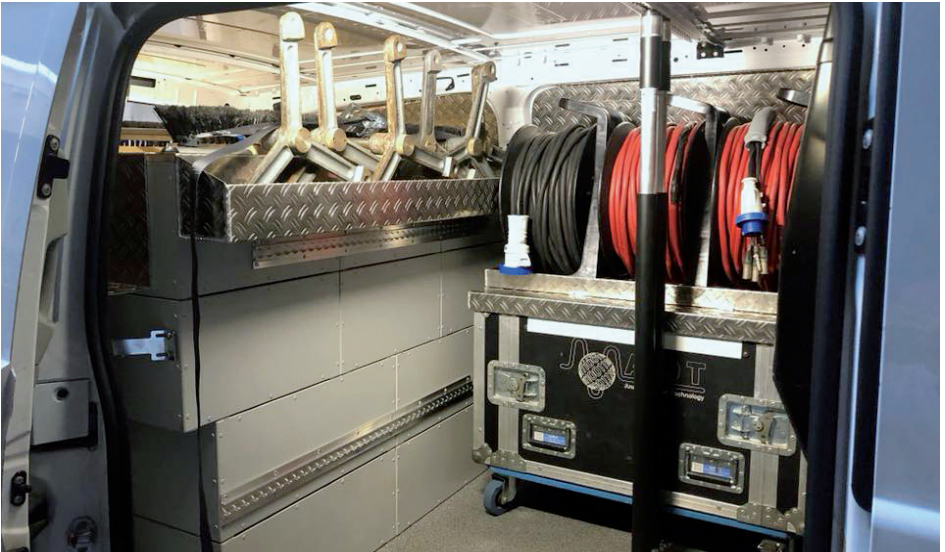
(Quelle Pallabazzer) Ausbau mit Schienensystem
