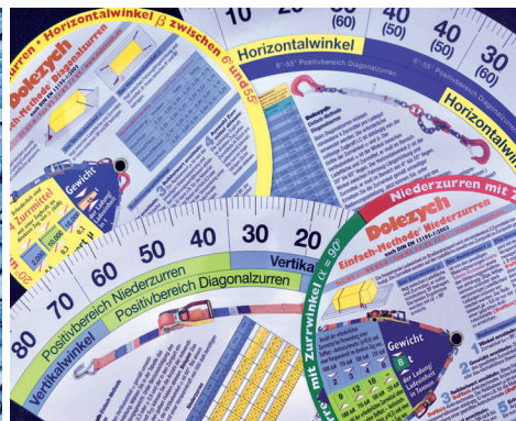
Einfache Winkelmesser und Umrechnungstabellen für Zurrgurte und Zurr-/Spannketten
