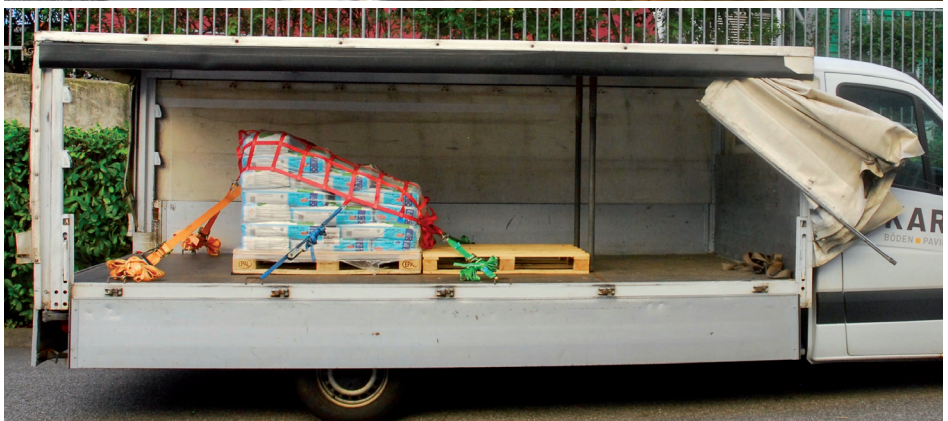
Verbesserung der vorhin gezeigten Methode mittels Kraftschluss und unter Einsatz einer Holzpalette und Deckenstützen
