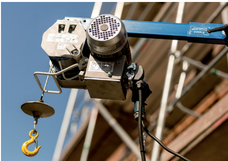
(Quelle: Böker) Klar sichtbare max. Belastung der Hubeinrichtung und Hubendbegrenzer vor der Seiltrommel.
