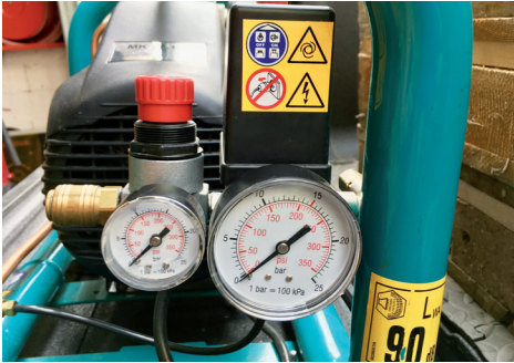
Ventil zur Einstellung des Betriebsdruckes und Manometer
