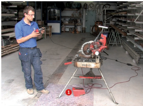
1 Fußschalter mit selbsttätiger Rückstellung
