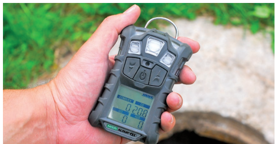
Gasmessgerät mit 4 Messsensoren (Sauerstoff, Schwefelwasserstoff, Kohlenmonoxid und Exgefährliche Gase) – vor dem Einstieg in begrenzte Behälter oder Schächte ist immer eine Notfallplanung und auf jeden Fall eine Sondierung mittels Gasmessungs - Detektoren durchzuführen. Die eingesetzten Personen müssen diesbezüglich genauestens unterrichtet und geschult werden.
