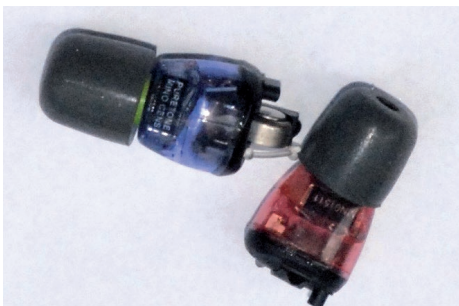
Aktive Gehörschutzstöpsel, durch ein Mikrophon werden die Umgebungsgeräusche bei Bedarf verstärkt und schädliche Geräusche abgedämpft.
