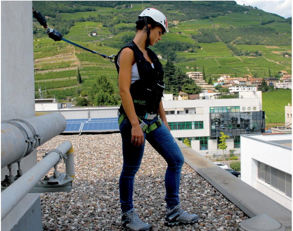
Einsatz eines Höhensicherungsgerätes
