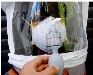
Dichtheitstest mittels speziellem FIT TEST, dieser überprüft den korrekten Sitz der Maske mittels Geruchstest
