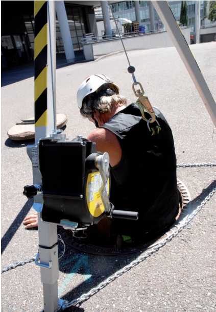
„Dreibein“ und Höhensicherungsgerät, mit integrierter Rettungsfunktion (Seilwinde) für den sicheren Zustieg in Schächte, unterirdische Tanks oder Silos
